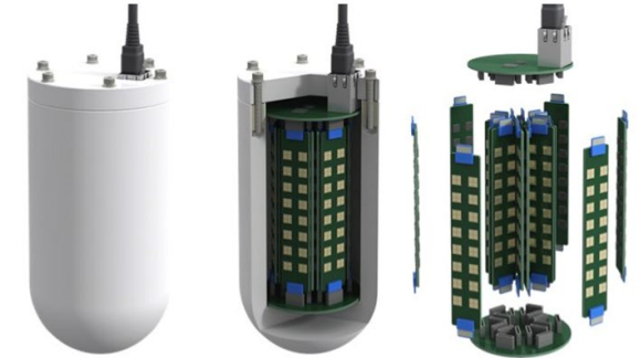
ダイヤ検出器搭載臨界監視モニター(CLADS英知)
