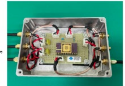
ダイヤ素子搭載ユニットアンプ回路と動作テスト機
