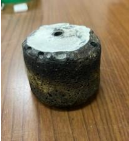
模擬デブリサンプル (Zr:Pb = 2:1 (Zr: 336 g、Pb: 174 g) の比率でインゴット状に作製)
