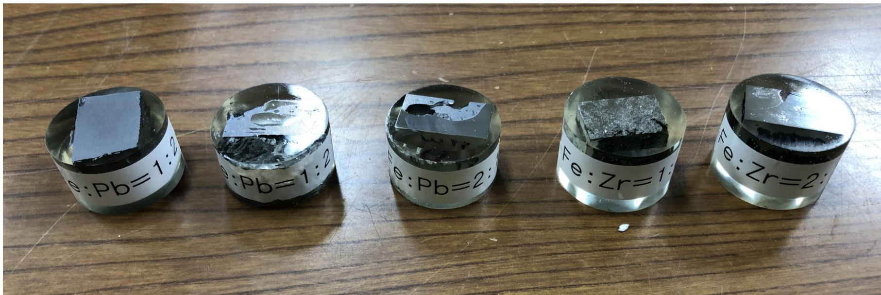
模擬燃料デブリ Pb/Fe/Zr 溶融試料
