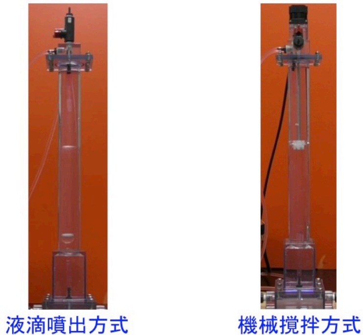
図 34 相分離の観測に特化した観測装置の構造
