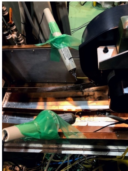
図 3.2-12 試験空洞による高周波電場測定の様子
