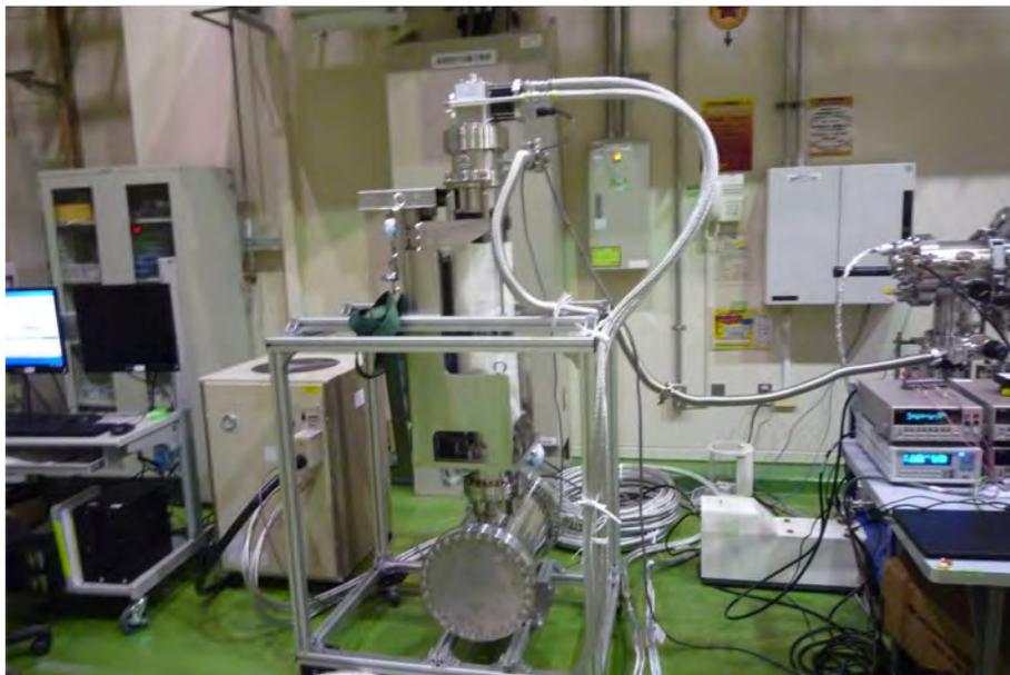
図 3-33: 真空試験および低温試験の状況（上：冷凍機および輻射熱シールドの外観、下：真空チェンバに組み込み試験を行った外観）
