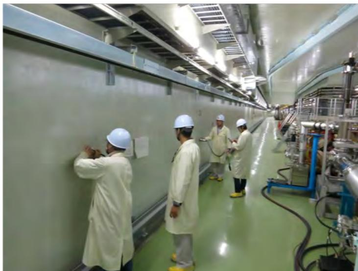
図 3-36: MR トンネル内への OSL 線量計設置状況
