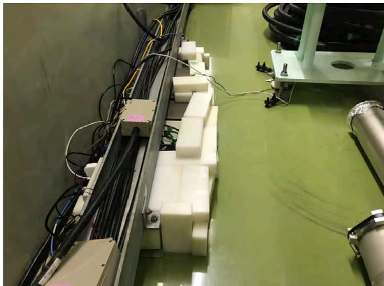
図 3-39: MR に設置した抵抗測定機器におけるポリエチレン遮蔽
