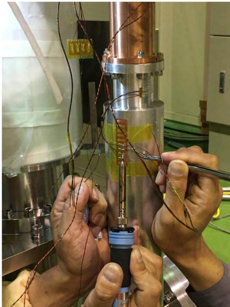
図 3-35: ヒートアンカー設置状況
