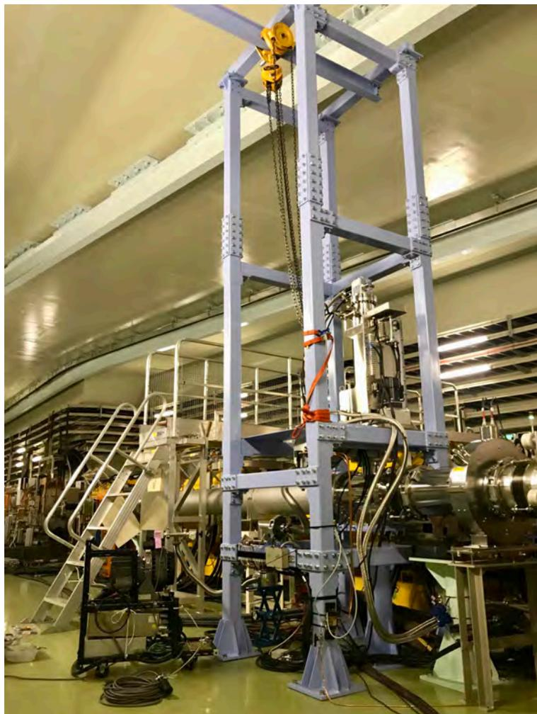
図 3-38: MR に設置した真空チェンバおよび冷凍機
