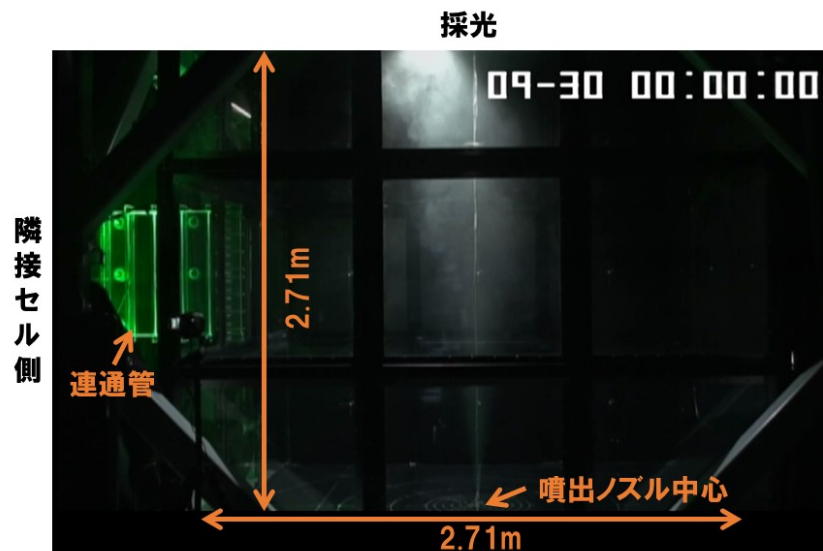
図 3. 3. 1-13 水平配置における実験での基準セル模擬粒子噴出状況
