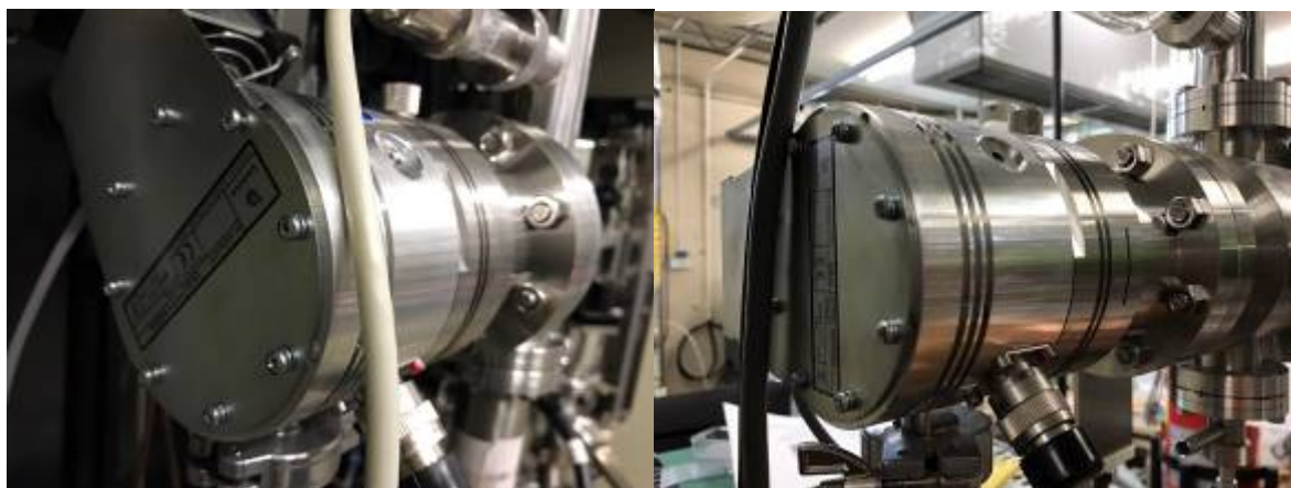
図 3.1-7 合成チャンバー(左)、基板交換用ロードロックチャンバー(右)に新たに接続したターボ分子ポンプ
