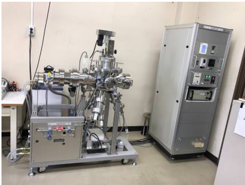
図 3.1-39 電極、絶縁膜製作用 RF スパッタリング装置 (Pascal, ST-3SC-S)
