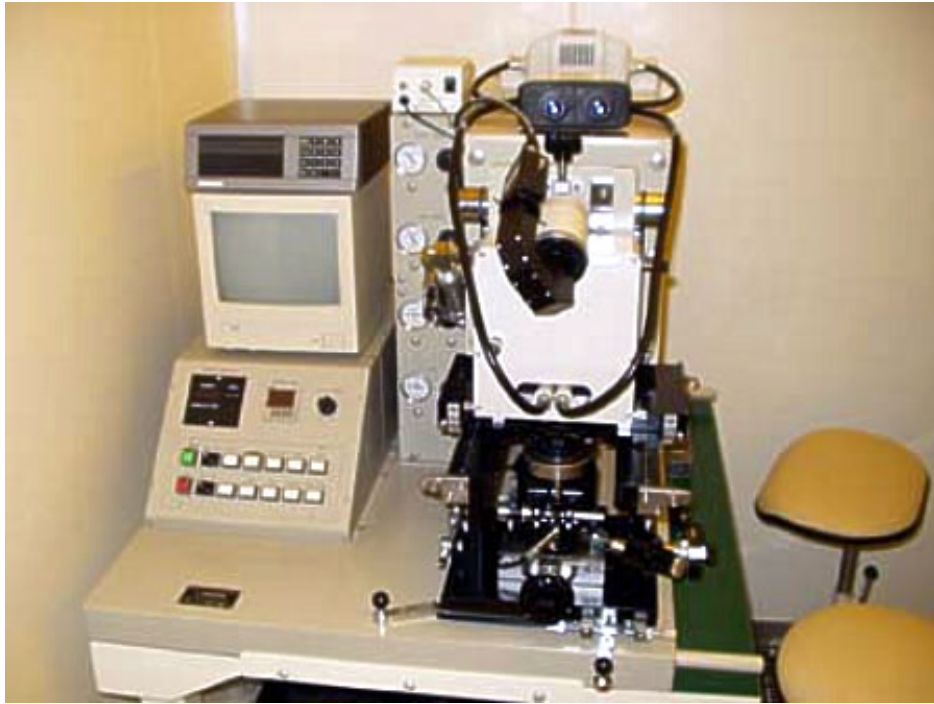
図 3.1-36 マスクアライナー (MIKASA, MA-20) 於 北海道大学 オープンファシリティ 創成科学研究棟 Room 01-101 [クリーンルーム]
