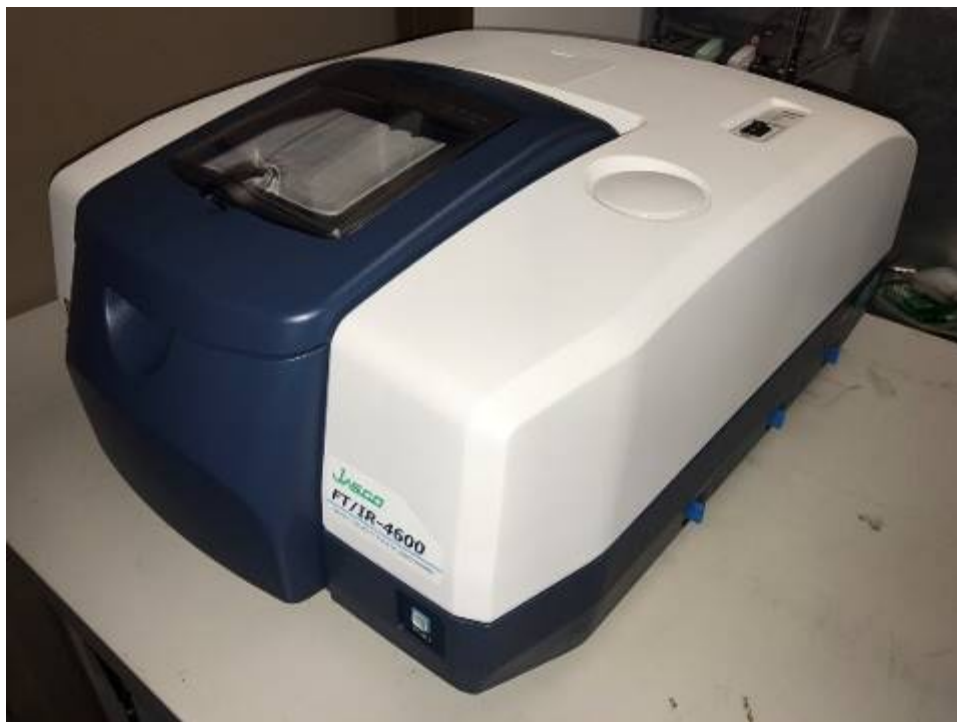
図 3.1-62 FT-IR 装置 (JASCO、FT/IR-4600)
