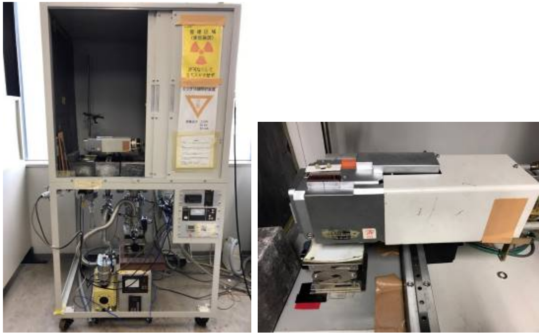
図 3.1-61 X線照射装置(Regaku, 4037B) (左)、使用したX線管ターゲット(Cr) (右)
