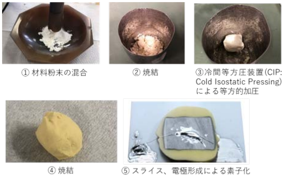
図 3.1-68 高温誘電体を使用したキャパシタの作製手順
