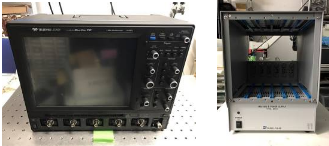
図 3.1-10 オシロスコープ(TELEDYNE LECROY, WaveSurfer 10) (左)とミニビン電源(CLEAR-PULSE, MODEL: E6660) (右)
