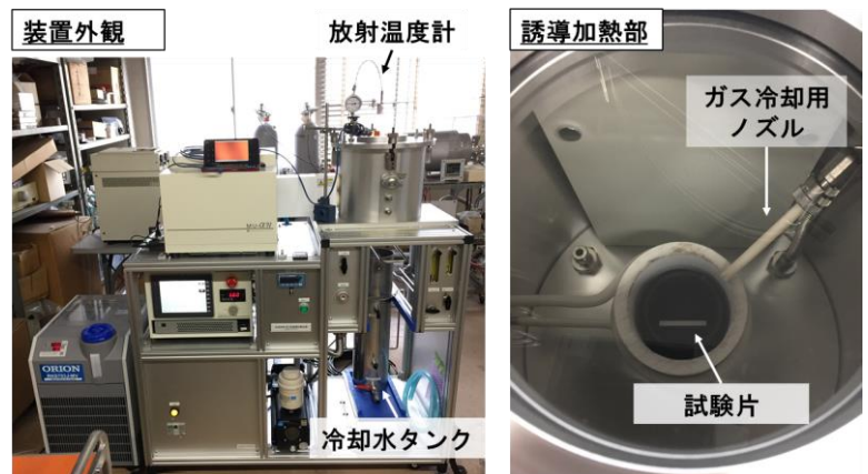
図 3.3.2-1 急速加熱・急冷熱衝撃試験装置外観及び誘導加熱部
