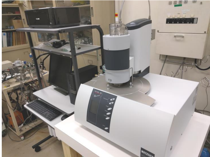
図 3.3.2-5 平成 28 年度に導入した高温示差走査熱量計の外観
