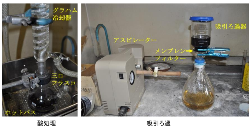
図 3.2.1-1 CNT の酸処理
