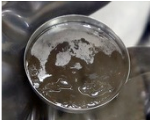
(c) TiN 粉末との湿式加振混合 (左：超音波加振直後、右：ヘプタン除去後)
