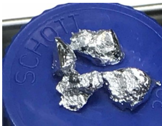
図 3.3.2-14 液体 Ga-Cd 合金 (53 at%-Cd) を急冷した試料の外観
