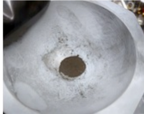
(b) TiN 粉末との乾式機械混合
