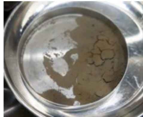
(c) TiN 粉末との湿式加振混合 (左：超音波加振直後、右：ヘプタン除去後)
