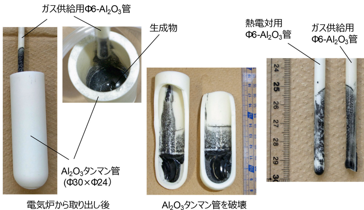
図 3. 2. 2-21 Run 2 終了後の Al 2 O 3 タンマン管と生成物、Al 2 O 3 管の様子
