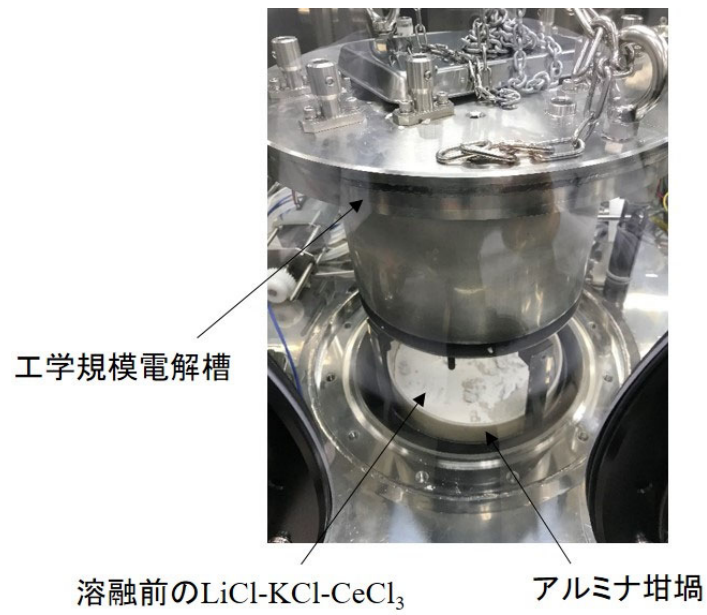
図3. 2. 3-1 工学規模電解槽に設置した電解浴
