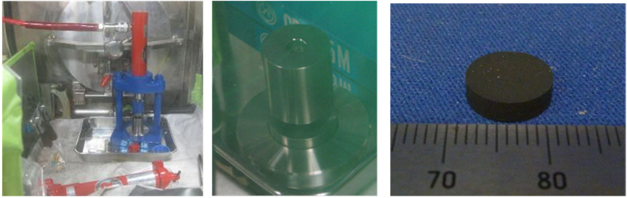
図 3.2.1-8 プレス台へのダイス設置図(左)、加圧後ダイス外観図(中)、模擬 MOX ペレット外観図(右)
