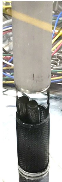
図 3.2.3-4 対極バスケットアセンブリ (電解試験終了後)
