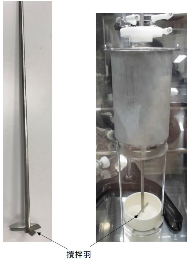
図 3.2.3-3 液体 Ga 電極アセンブリで用いた攪拌羽 左：令和元年度試験、右：平成 30 年度試験
