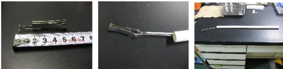
図 3.2.1-10 曲げ加工後 Pt 板(左)、Pt 板+Pt 線取り付け部(中)、Pt 電極全体(右)
