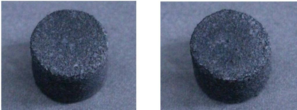
図 3.8.2-7 70Cs<sub>2</sub>CO<sub>3</sub>-30YD<sub>2</sub> ターゲット (粉末混合焼結型)
