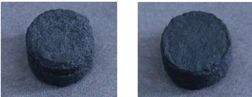
図 3. 8. 2-6  $40BaI_2-60YD_2$  ターゲット (粉末混合焼結型)
