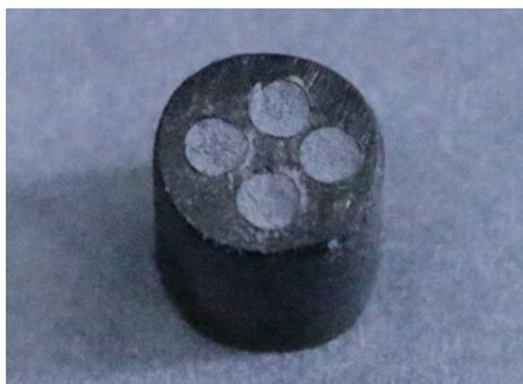
図 3.8.2-9 10BaI<sub>2</sub>-90YD<sub>2</sub> ターゲット (混合複合体型)
