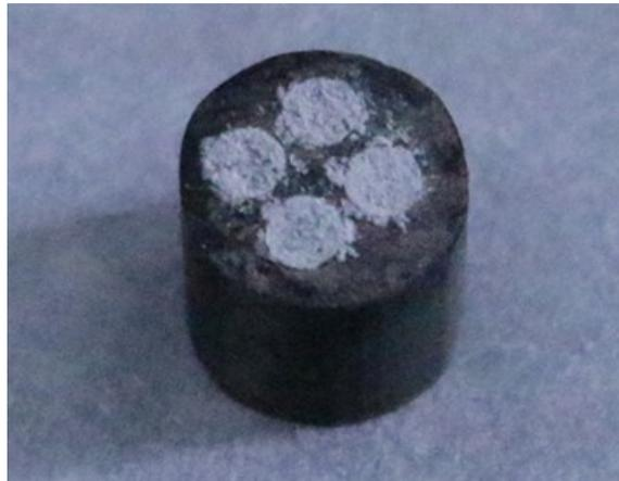
図 3. 8. 2-10  $10\text{Cs}_2\text{CO}_3-90\text{YD}_2$  ターゲット (混合複合体型)
