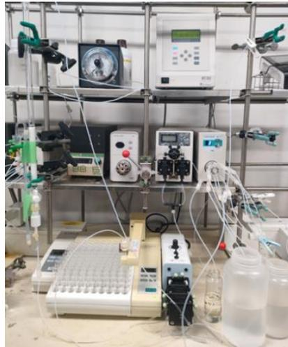
図 4.2.2.2-2 オーバーフロー式重力流カラム試験装置の外観写真
