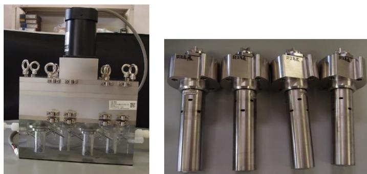
図 4.1.3.1-4 逆抽出段②に使用した4段型遠心抽出器
