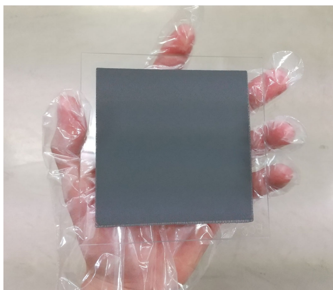
図 3.3-3 加熱硬化型エポキシ樹脂をバインダーに用いて作製した \text{B}_4\text{C} 膜の外観
