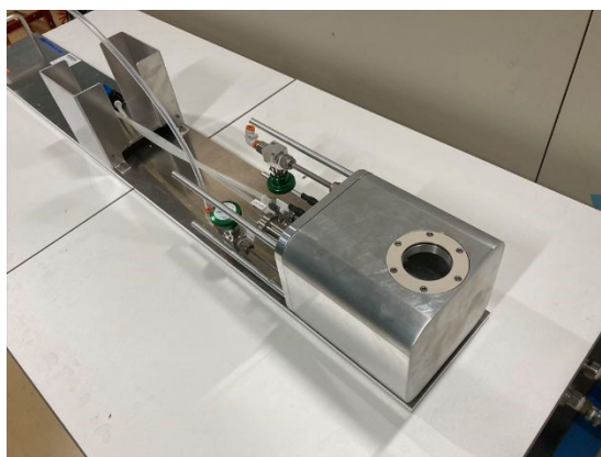
図 3.1-10 試料ステージを内包したアルミチェンバー
