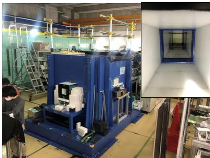
図 3.1-11 RANS 遮蔽体のビーム取り出し側と照射口内部
