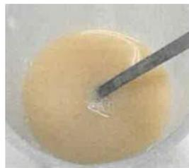
図 3.2-2 遠心分離操作 (600 G、10 min) により回収された酵母細胞 (含水率 73 wt%)
