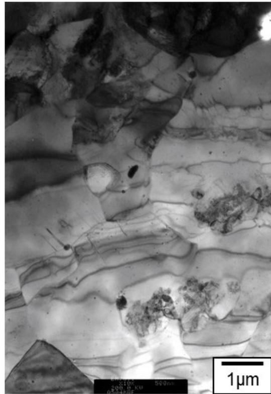
図 3.3-6 9Cr-ODS 鋼 (Mm14) の事故模擬超高温加熱後のミクروسケール TEM 観察像
