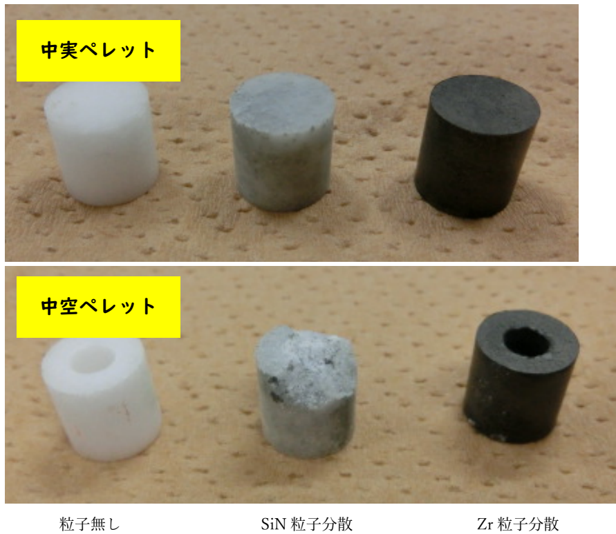
図 3.1-17 作製した粒子分散サンプル (上：中実ペレット、下：中空ペレット)
