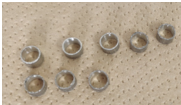
図 3.1-13 中空加工をした Sn-Bi 模擬合金ペレット (直径 8 mm×長さ 5 mm×厚さ 0.5 mm)
