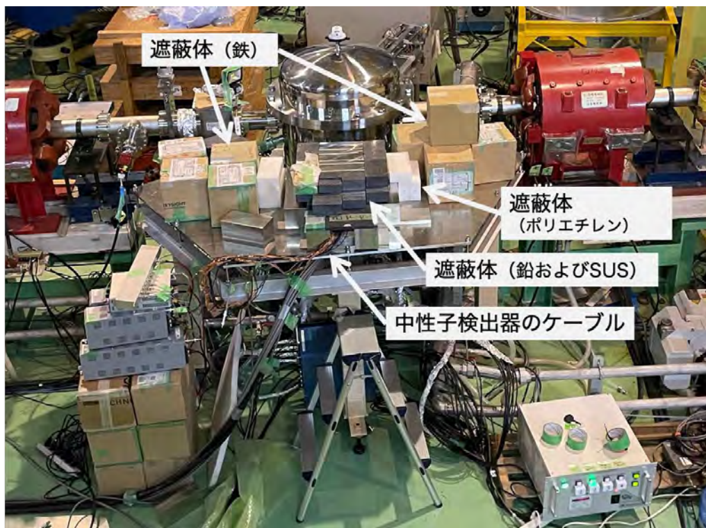
図 3-157 核分裂中性子測定に用いた実験体系の様子（中性子検出器周辺に遮蔽体を設置し、測定は 90° 方向のみ実施した。中性子検出器は重厚な遮蔽体内に設置したため、本映像では確認できない）
