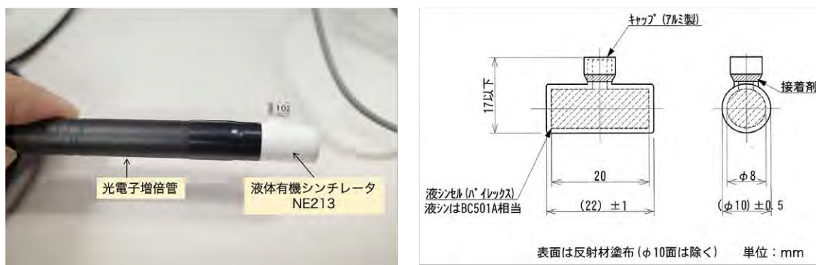
図 3-1 実験で使用する液体有機シンチレータ EJ-301 と光電子増倍管（接続部およびシンチレータは遮光効果を持つ素材テープで覆う）
