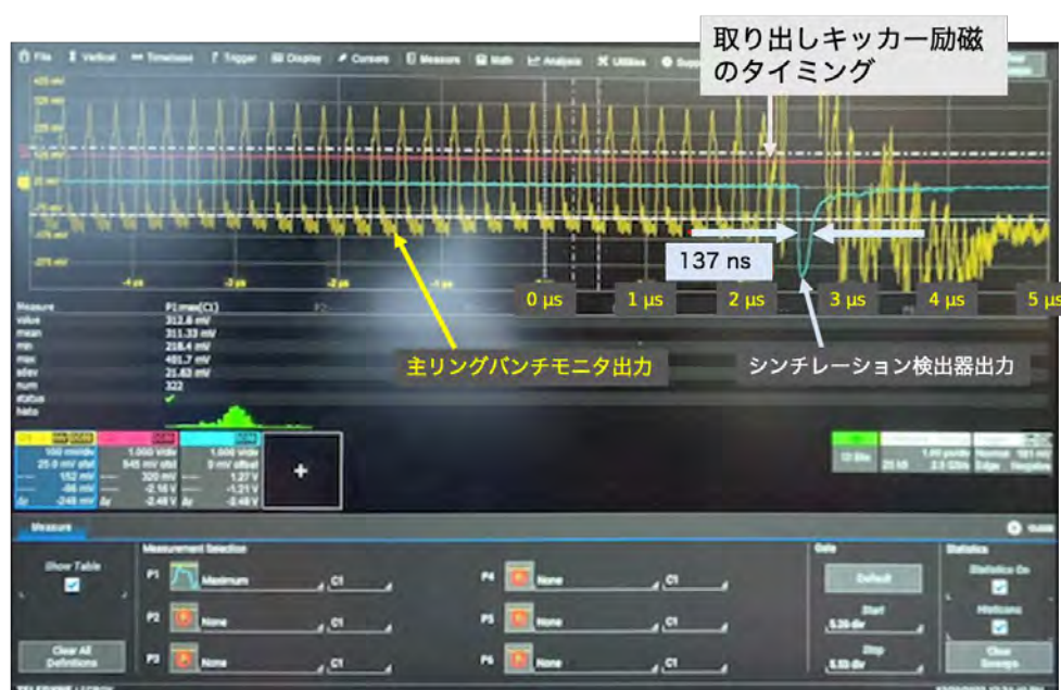
図 3-105 プラスチックシンチレーション検出器の出力信号（淡緑色）と主リングバンチモニタの出力信号（黄色）
