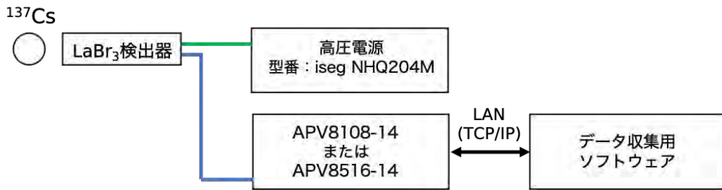
図 3-112 エネルギー分解能測定セットアップ
