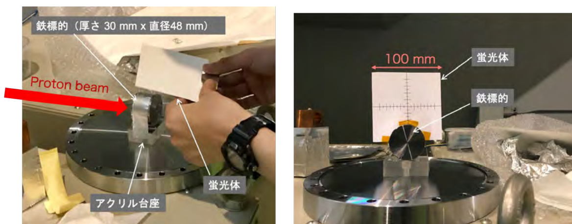
図 3-46 TTNY 測定用鉄標的の設置の様子
