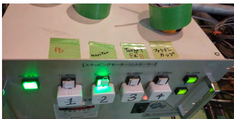
図3-59 ステッピングモータの外観（ボタンを押すと該当の番号の標的等がビーム照射位置に移動する）
