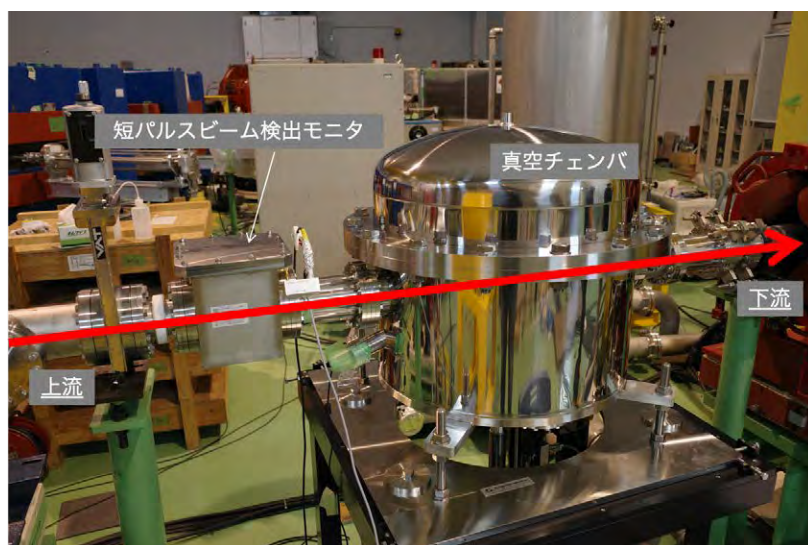
図 3-93 真空チェンバ上流側近傍のビームライン上に設置された短パルスビーム検出モニタ
