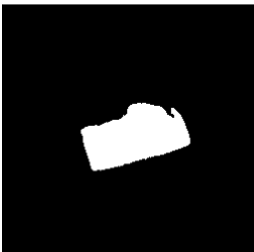
図 3-43 [3.95 MeV] スライス#400 (サンプル 2) における二値化画像 (白色ピクセル:模擬 デブリ領域)
