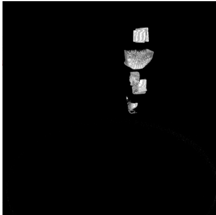
図 3-36 [950 keV] 3次元 CT の結果 (Pb のみの領域)
