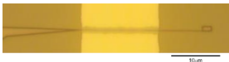
図 3.1.13 セルフアライン法によるゲートパターン、ソースドレイン間形成後
