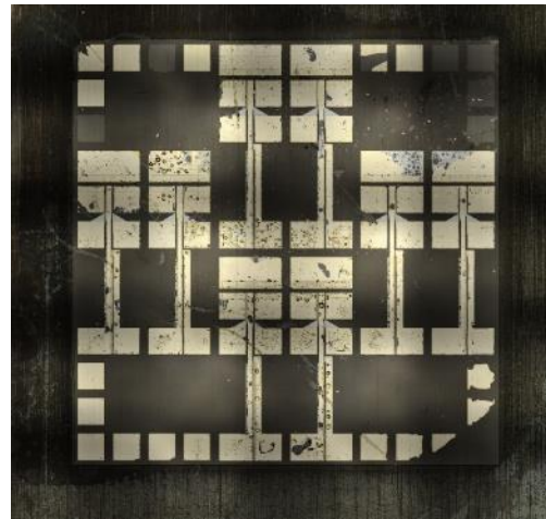
図16 ダイヤモンド基板の様子 (400°C加熱試験後)
