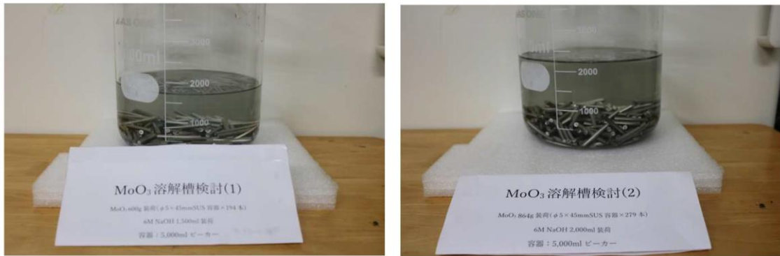
図 3.1.3(3)-5 溶解槽容量模擬試験
