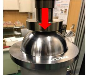
図 3.1.1(2)-7 平床接触球殻試験体の外観
