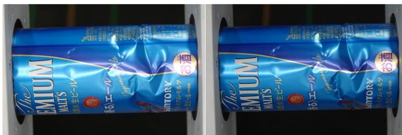
図 3.2.1(1)-33 試験体 A 30 Hz、40 m/s<sup>2</sup> 1 回加振後（左）と 3 回加振後（右）
