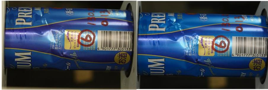
図 3. 2. 1(1)-37 試験体 B 30 Hz、40  $m/s^2$  1回加振後（左）と3回加振後（右）
