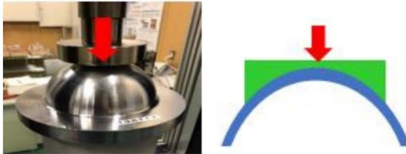
図 D6-8 小型球殻試験体による座屈試験 [13]
