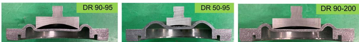
図 3.1.1(2)-14 試験後の試験体の変形状態（球面座接触球殻）
