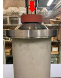
図 3.1.1(2)-11 球面座接触球殻試験体の外観と球面座
