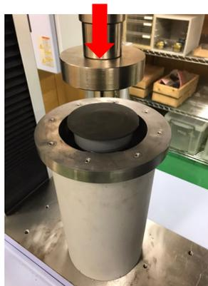
図 3. 1. 1 (2)-21 炉心支持構造試験体の座屈試験方法
