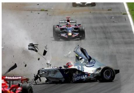
レーシングカー車体は、ノーズ部の強度がコックピット強度より低いため、衝突時にノーズ部破壊が先行して衝撃力を低減し、コックピット内のドライバーを保護
