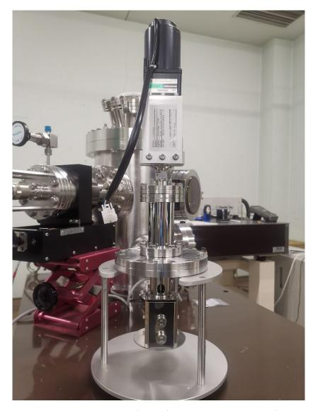
図 3. 2. 4-2 管状試料用のレーザーアブレーションの試料ホルダ
