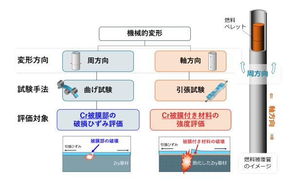
図 3.2.1-1 機械試験の概要と位置づけ
