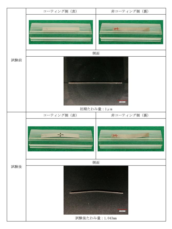
図 3.2.1-23 外観写真 試験体名:B23-LAB-4\_RT
