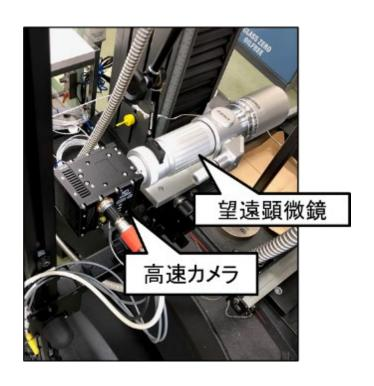
図 3.2.1-12 令和 2~令和 4年度 室温/高温 3点曲げ試験のその場観察用セッティング
