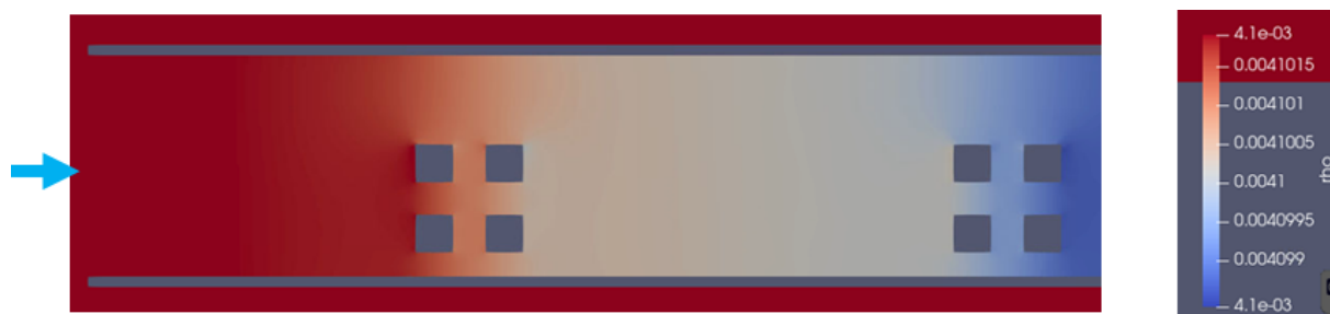
図 3.1.2-70 立体クロス形状サンプル周辺の密度分布（管軸平行断面）
