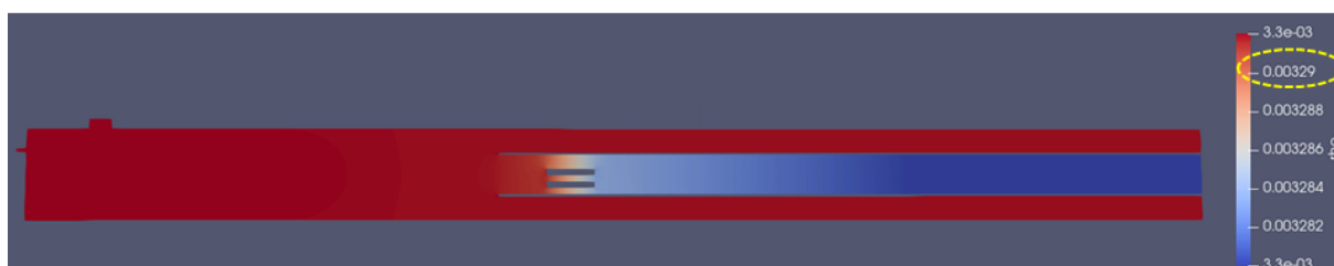
図 3. 1. 2-13 オリフィス無しの場合の計算モデル全体の密度分布（管軸平行断面）
