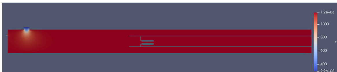
図 3.1.2-23 平板オリフィスの場合の計算モデル全体の温度分布（管軸平行断面）
