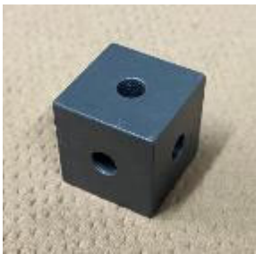
図 3.1.1-13 SiC モックアップ試験片の外観写真 表 3.1.1-3 SiC モックアップ試験片への被覆試験条件
