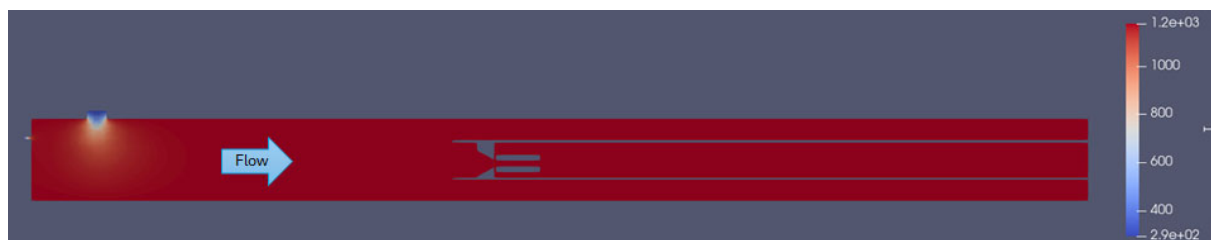
図 3. 1. 2-36 テーパー型オリフィスの場合の計算モデル全体の温度分布（管軸平行断面）
