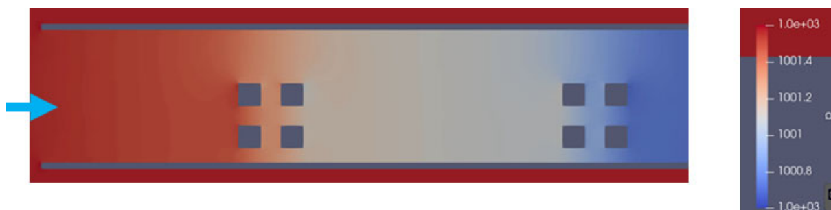
図 3. 1. 2-69 立体クロス形状サンプル周辺の圧力分布（管軸平行断面）
