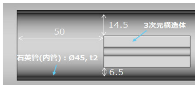
図 3. 1. 2-8 計算体系における 3 次元構造体の近傍
