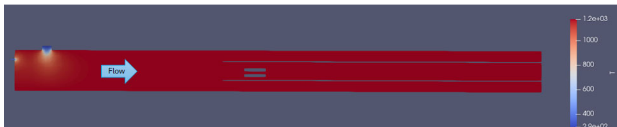
図 3. 1. 2-11 オリフィス無しの場合の計算モデル全体の温度分布（管軸平行断面）
