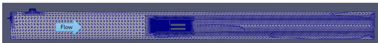
図 3.1.2-20 計算モデル全体のメッシュ概略（管軸平行断面）
