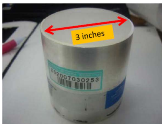
図 3.6 F11 に置かれた電離箱と \text{LaBr}_3 の写真 (左)。 \text{LaBr}_3 は直径 3 インチの大きな結晶を利用している (右)
