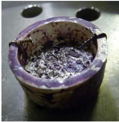
図 3.1-26 熔融 \text{LiCl-KCl-1.6wt\%UCl}_3 中における電気化学測定後の液体 Ga 電極の外観写真
