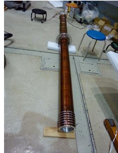
図 3.1-20 真空ダクトの外観写真
