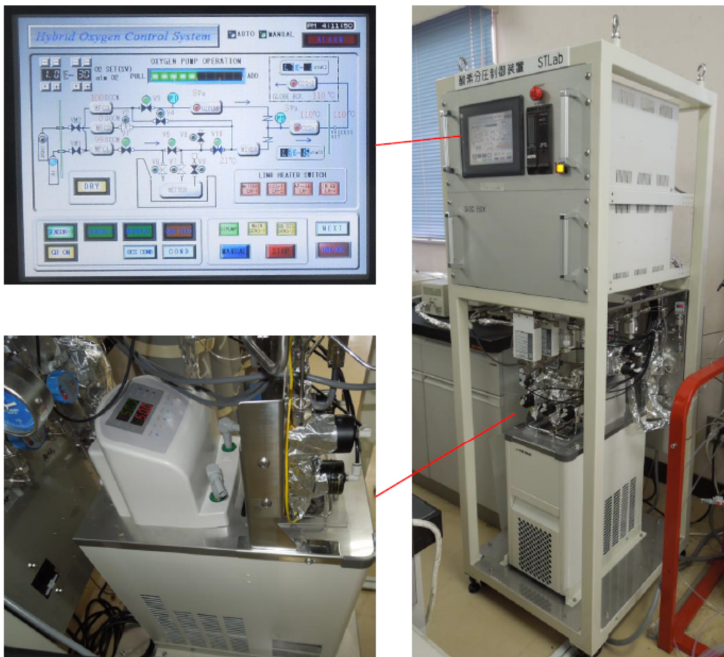
図 3.2.3-2 酸素分圧制御装置外観
