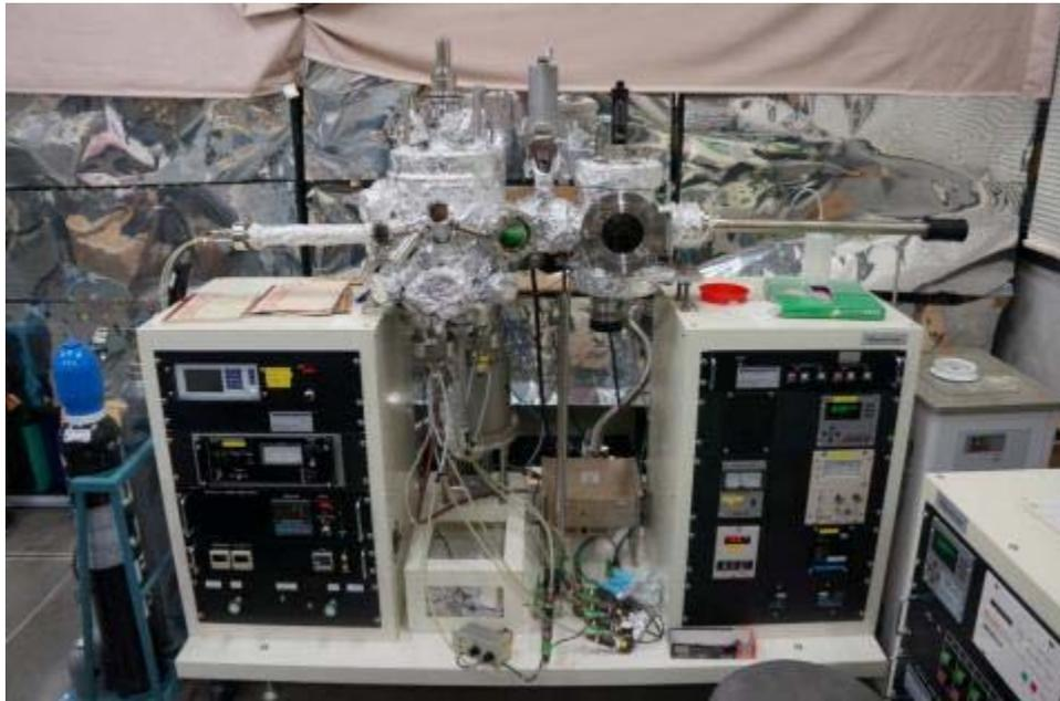
図 3-2-2 Ti 及び WC 電極形成に用いたマグネトロンスパッタリング装置
