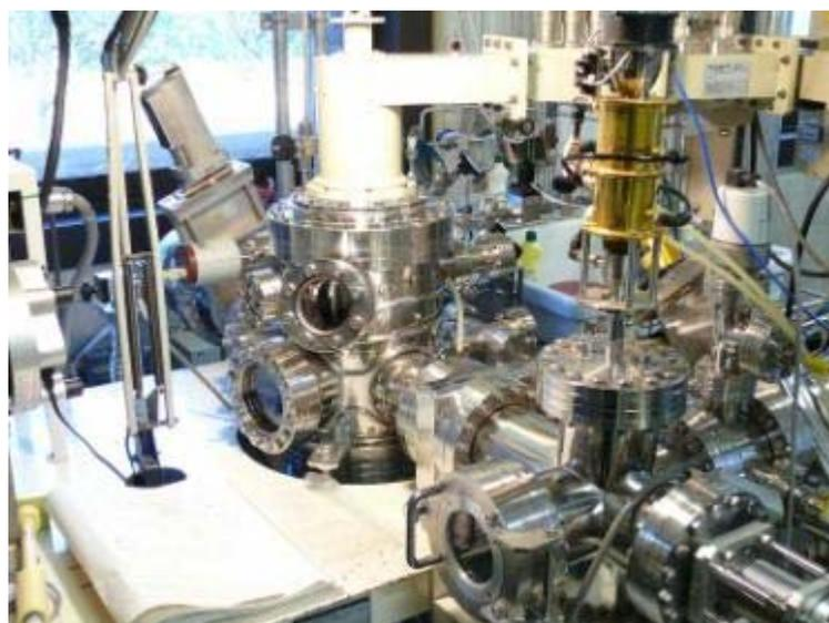
図 3-2-6 n 型ダイヤモンド合成実験に用いた NIMS 型マイクロ波プラズマ CVD 装置
