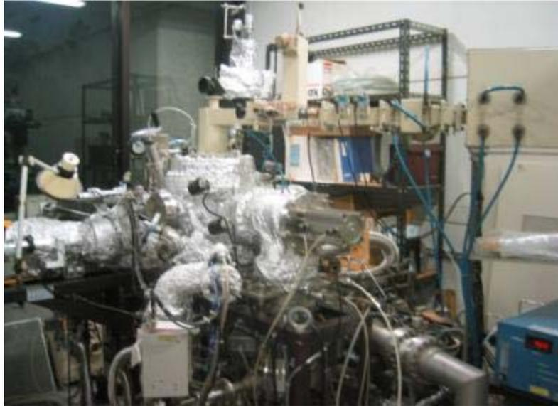
図 3-2-1 ホウ素ドーパダイヤモンド薄膜成長に用いた NIMS 型マイクロプラズマ CVD 装置
