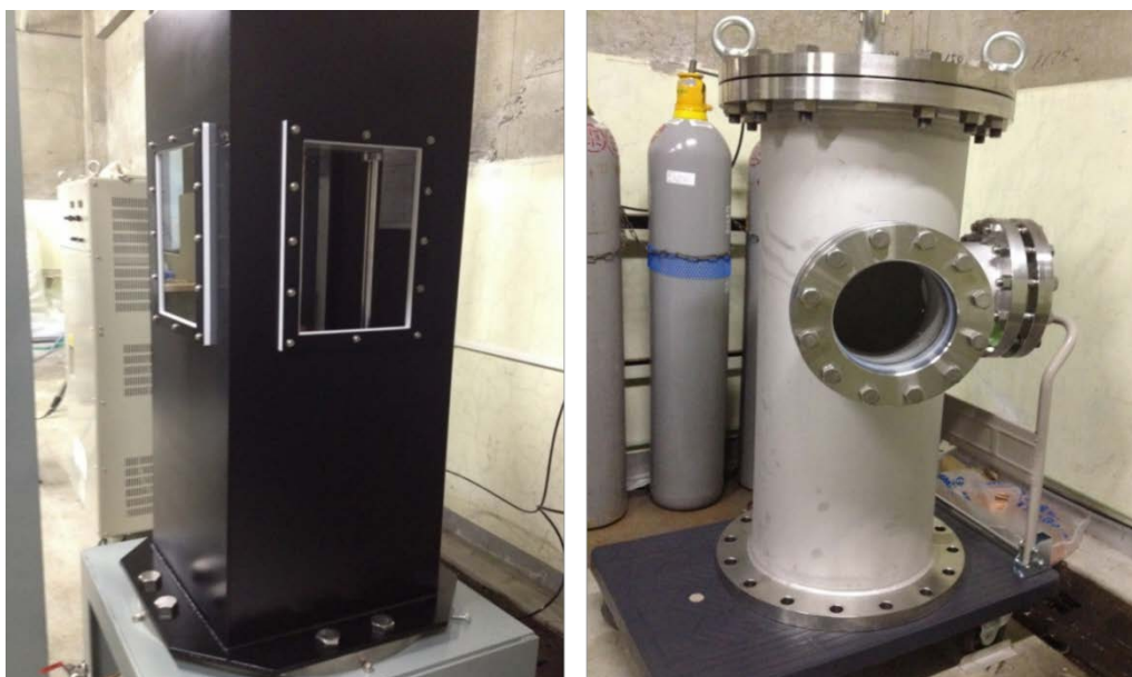
図 3.1.4 (1)-1 大気圧試験用圧力容器(左)、高圧試験用圧力容器(右)
