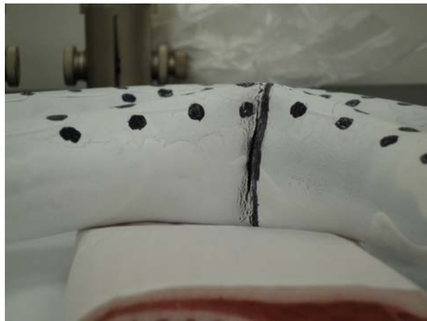
図 3. 1. 5 (2) ②-9 引張り-圧縮サイクル試験によるエルゴ部変形
