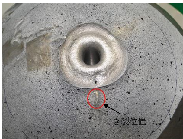
(d) 外面側外観 (き裂位置拡大)
