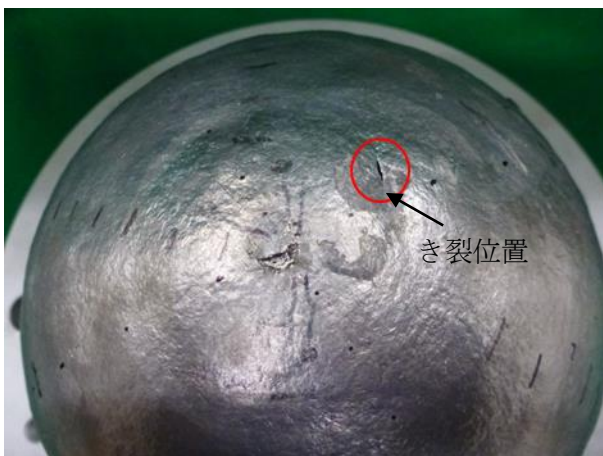
(d) 外面側外観 (き裂位置拡大)
