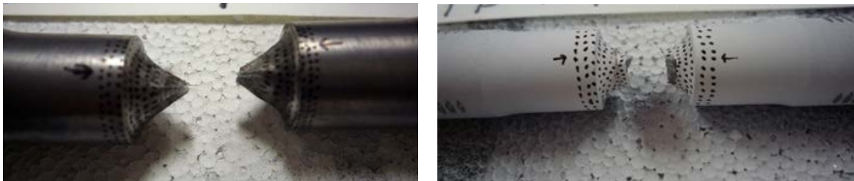
図 3.1.3(1)-3 各試験片の破断状況 (左：純鉛 右：鉛-アンチモン合金)
