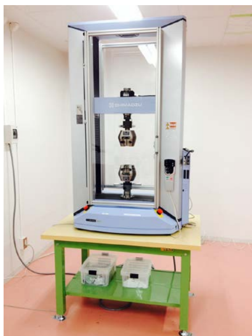
図 3.1.5(2)②-1 引張り試験機外観
