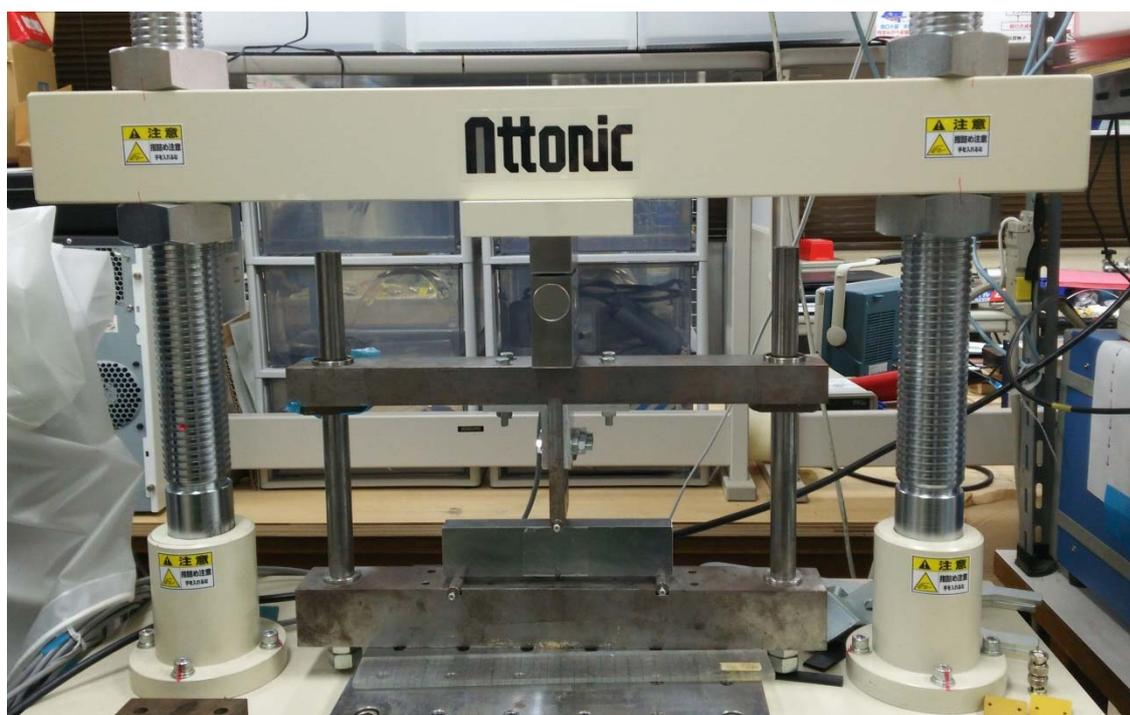
図 3.1.2-3 荷重負荷装置外観
