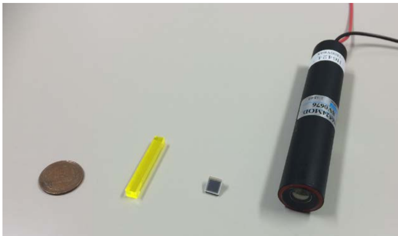
図 3.1-2 使用した GAGG シンチレータと MPPC、PMT の素子の写真。比較対象として 10 円玉を並べてある。MPPC の小型化に対する有利さと、外部から飛来するガンマ線に対する透明性が期待される。
