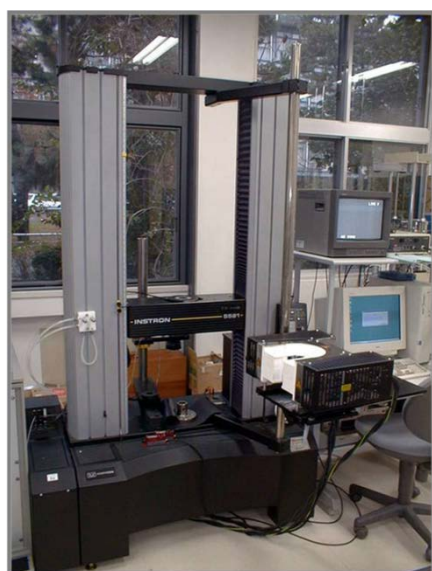
図 3.1.1-3 デジタル万能材料試験機の外形と仕様
