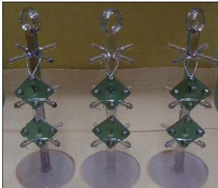
写真 3.2-7 石英ガラス製ホルダへの DBC 試験片の設置状況
