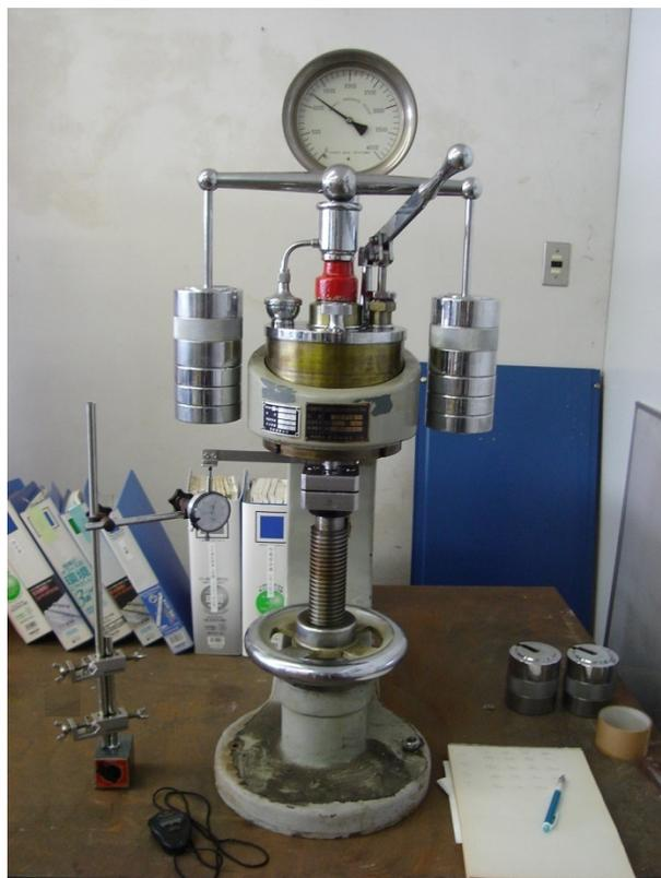
写真 3. 2-1 DBC 試験片の圧痕加工用ブリネル硬度計の外観
