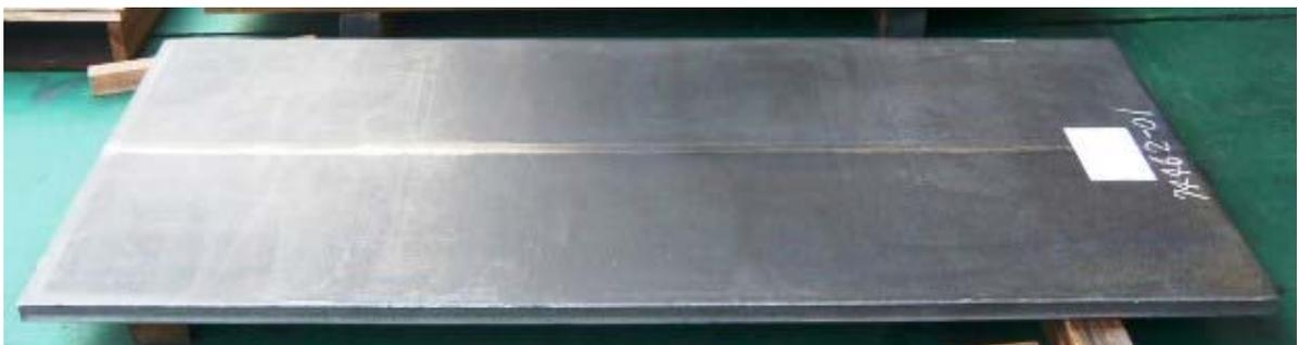
写真 3.1-7 爆着クラッド材⑥ (板組「EHP/SUS316/EHP」、 $(3+32+3)t \times 840w \times 2,000L$ ) の爆着後の外観写真
