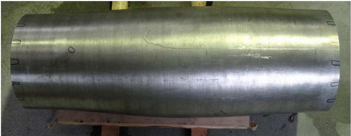
写真 3.1-6 クラッド材⑤ (板組「EHP/SUS316」、 $(4+31)t \times \phi 318 \times 1,000L$ ) の爆着後の外観写真
