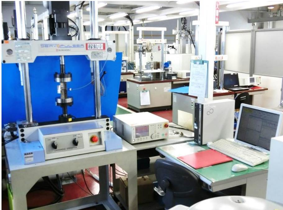
写真 3.1-72 疲労き裂伝播試験状況
