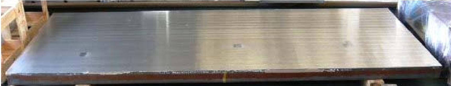
写真 3.1-1 圧延クラッド材①（板組「EHP/SQV2A」、 $(8+72)t \times 1,000w \times 3,000L$ ）の外観写真
