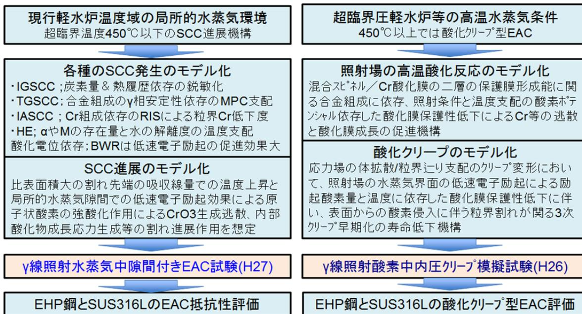
図 3.2-59 基盤知見の乏しい  $\gamma$  線照射場水蒸気特有の環境誘起割れ EAC の重要度評価
