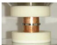
安定した応力状態、ひずみ比を達成
