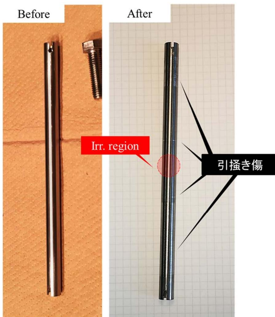
図 3.14.23 平成 27 年度に実施した照射試験における照射前後の試験片形状
