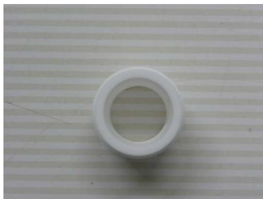
図 3.15.4 電子線加熱用の絶縁碍子の外観
