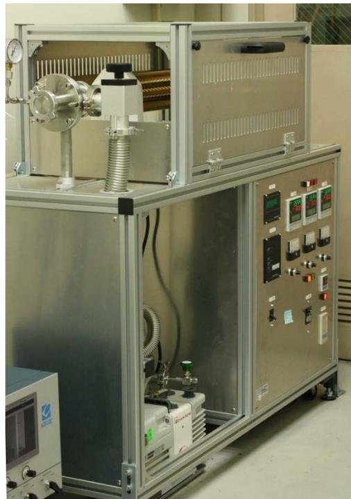
図 3.4.1 水素化試験装置の系統概略図と外観
