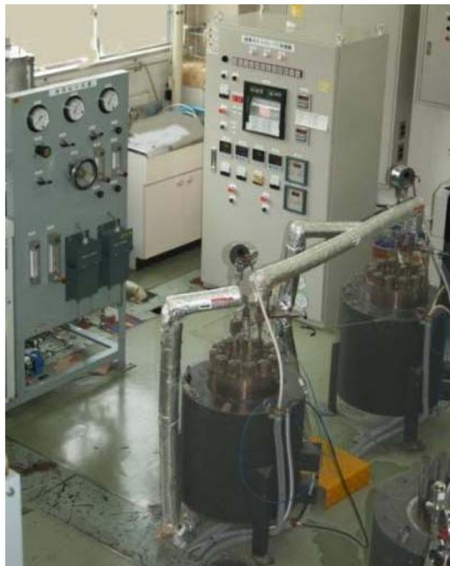
図 3. 3. 1 腐食試験（実機冷却材模擬水）用循環式オートクレーブ装置の系統概略図と外観
