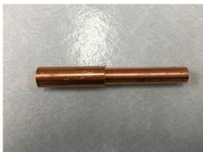
②旋盤加工で4 cm程度を直径8 mmに切削
