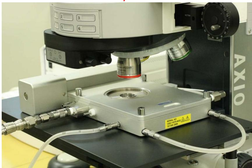
図 3.9.1 光学顕微鏡用引張試験装置の外観状況
