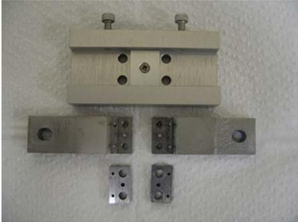
1) 高温クリープ試験用試料固定治具本体
