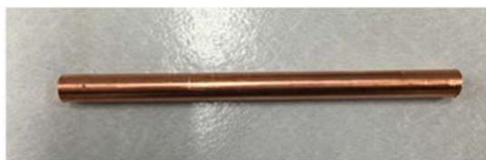
①ファインカッターで試料を8 cm程度に切断
