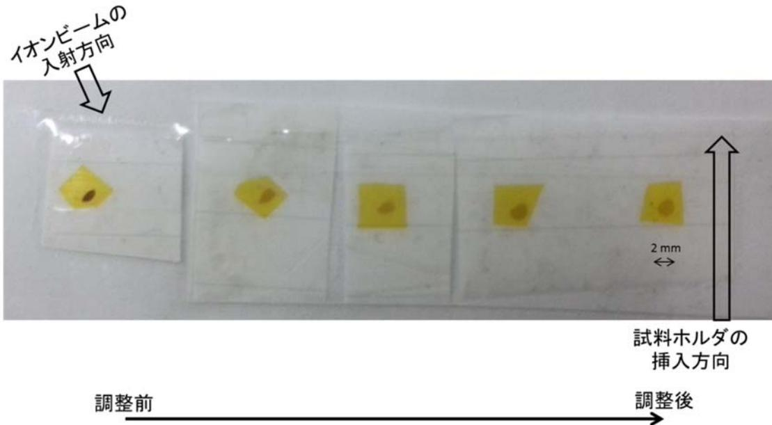
図 3.15.16 照射領域を確認するために使用したカプトンフォイルの一部
