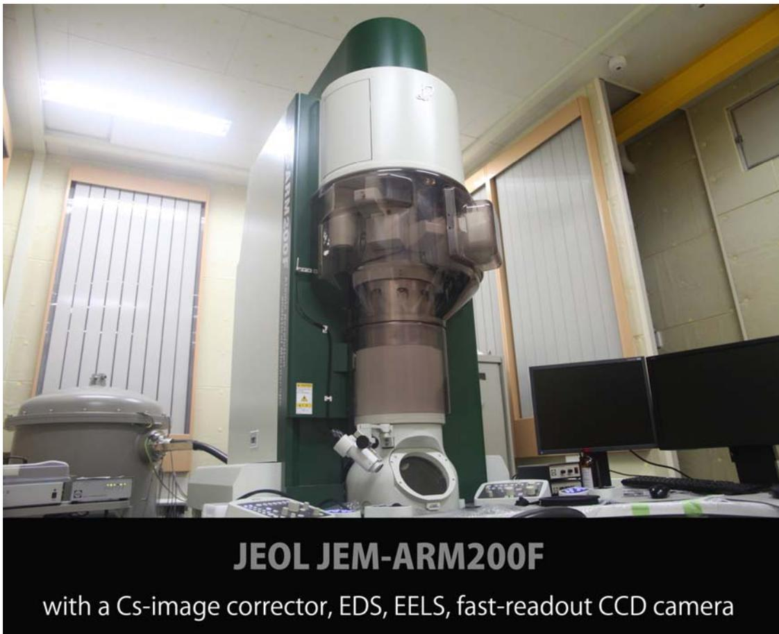
図 3.11.14 本研究で主に使用した TEM (東北大大洗キャンパスの JEOL ARM200F)
