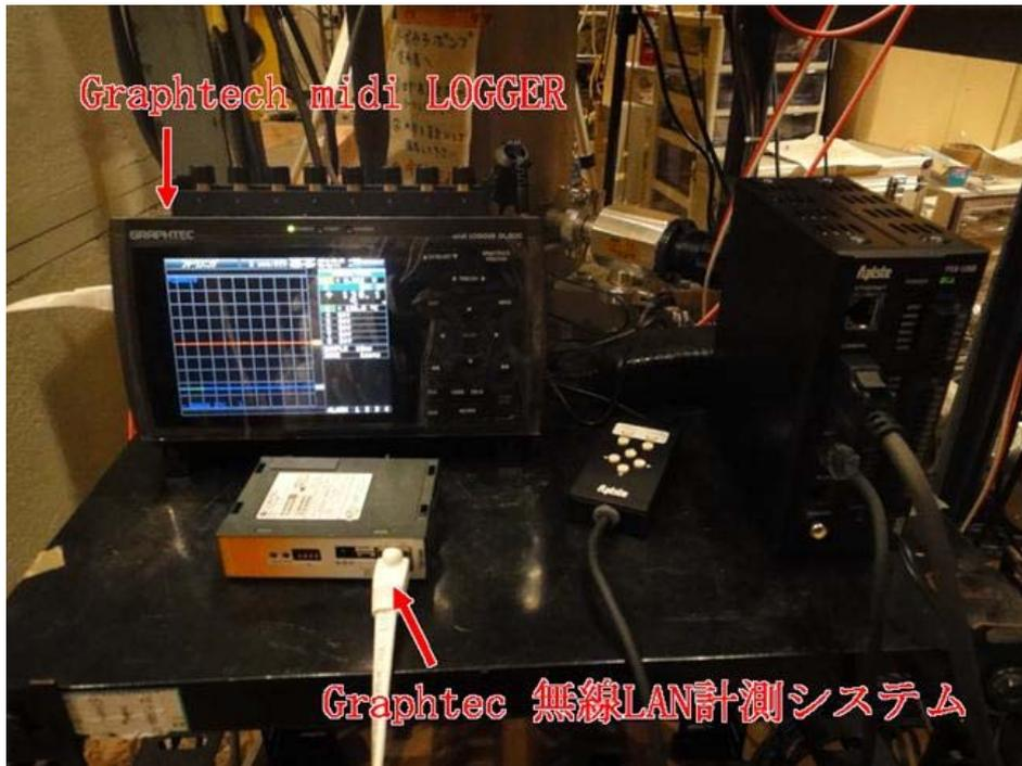
図 3.12.17 イオン注入計測システム設置後外観図
