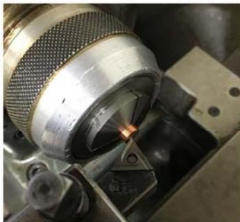
②旋盤加工で所定の高さまで加工
