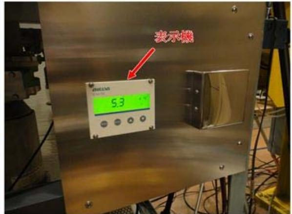
図 3.12.11 真空度測定装置設置後外観図
