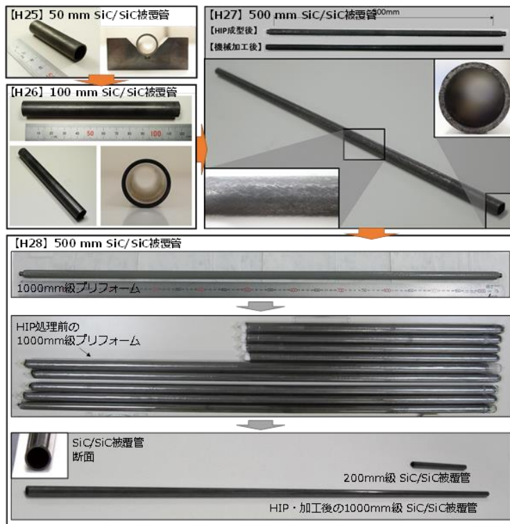
図 3.1-6 外径 12mm・肉厚 1mm・長さ 1m クラス SiC/SiC 被覆管
