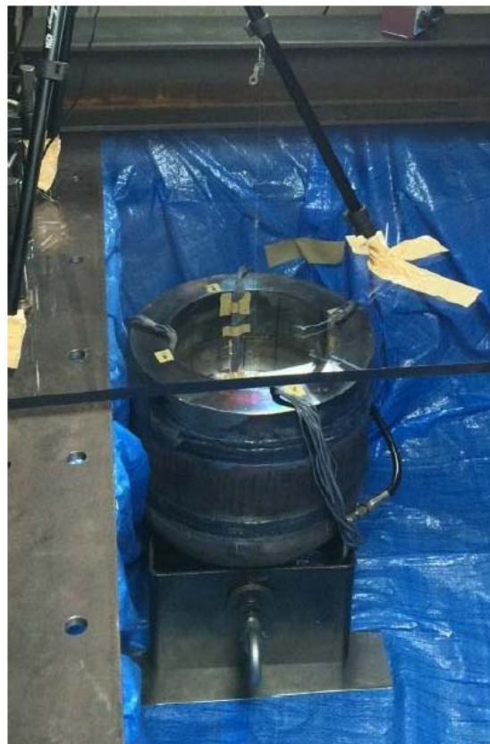
図 3. 2. 2-9 鏡板試験体試験体設置状況
