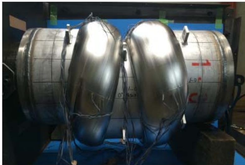
(c) 漏えい発生後 (試験終了)
