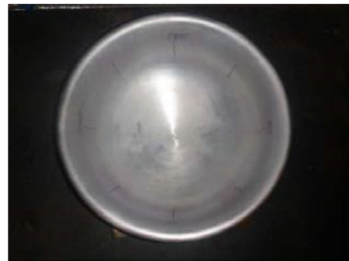
図 3. 2. 2-18 大口径 AD 型鏡板試験体の試験後の外観(板厚 8 mm)
