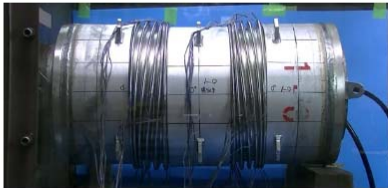
(b) 座屈状況 (約 0.27MPa、試験開始後 5:04 時点)
