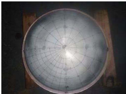
図 3. 2. 2-18 大口径 AD 型鏡板試験体の試験後の外観(板厚 8 mm)
