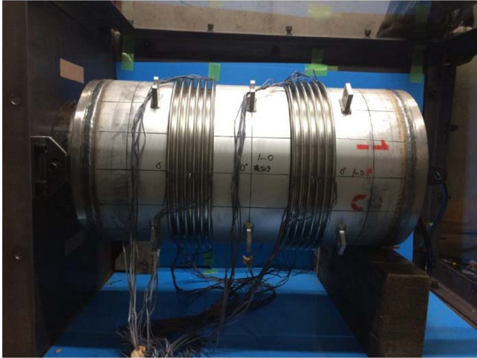
図 3.2.2-6 試験体 1-0 試験体設置状況（水平方向に設置）
