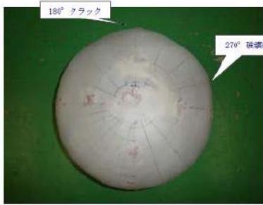
写真 5-1. 外側-01(クラック)
