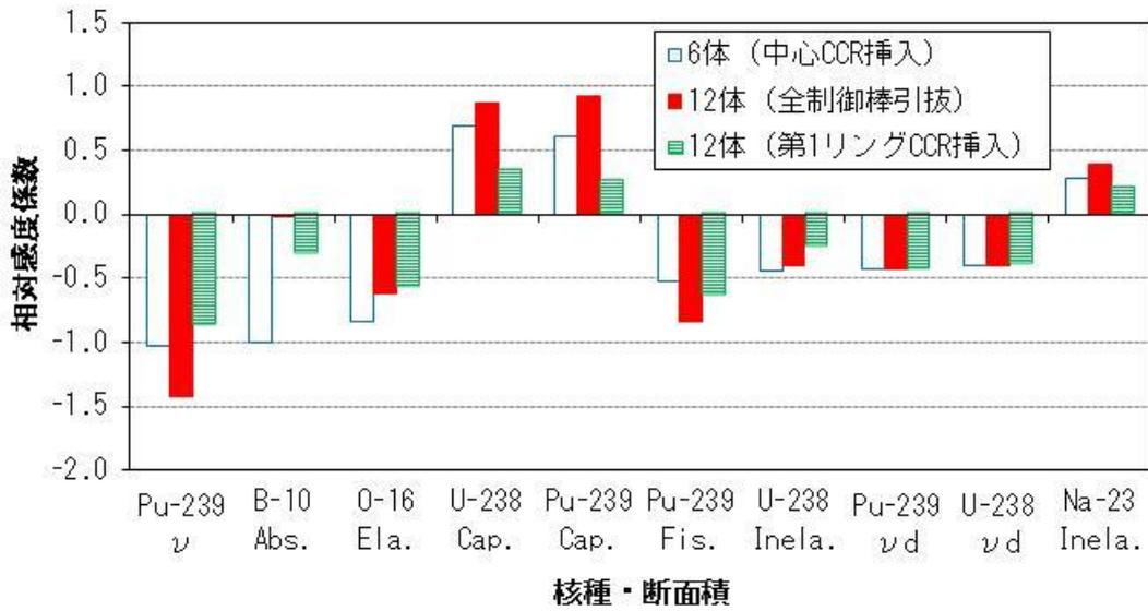
図 3.8.2-3 「もんじゅ」における冷却材反応度の1群感度係数の比較 (上位10個)
