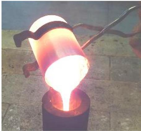
図 3.2-89 溶融ガラスの流し込み
