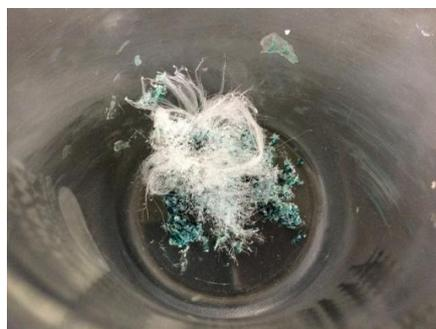
図 3.1-3 AIHCF#49B (Fe : Al = 1 : 3) の非加熱乾燥後の写真
