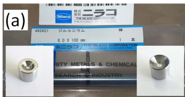
図3.2.4-2 作成したイオン源コーン(a)と加速器ビーム条件(b)
