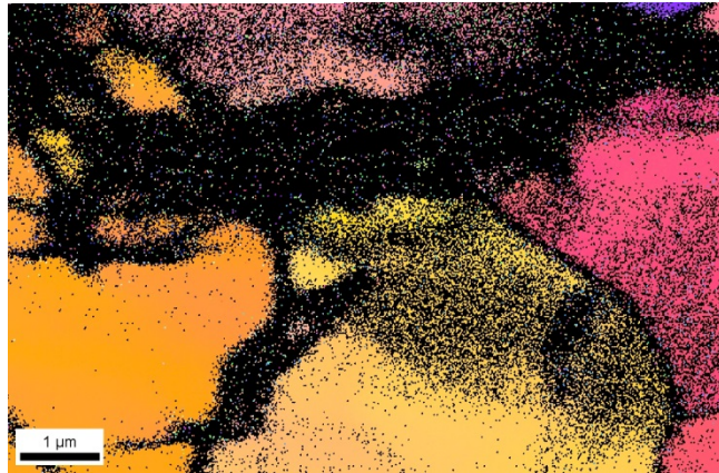
(1) 試験片の板厚方向 (TD 方向) での逆極点図 (IPF)
