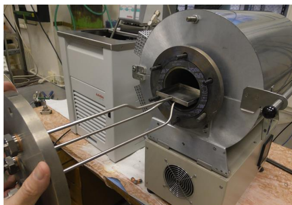
b. フッ化反応炉と試料ボート (横置型、観察窓無し)
