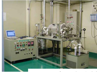
ボート炉試験装置
