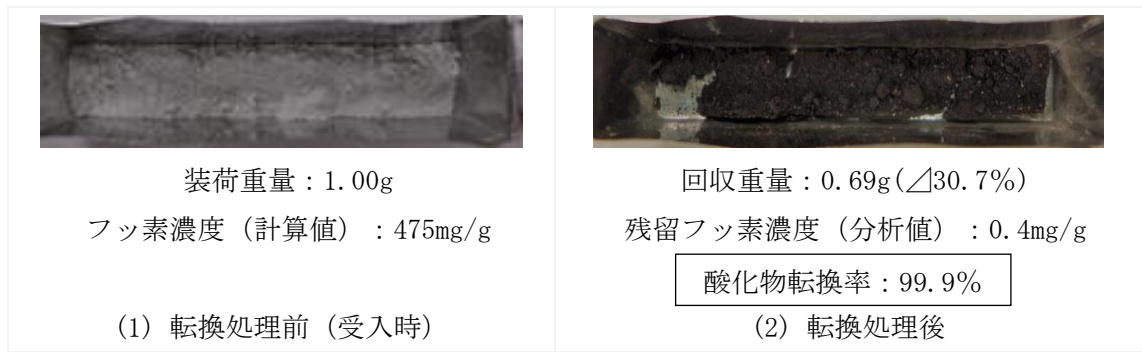
図 3.2.3-11 フッ化炉残渣試験における転換処理前後の外観及び酸化物転換率
