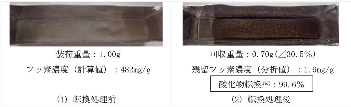
図 3.2.3-8 試薬試験③の転換処理前後の外観及び酸化物転換率
