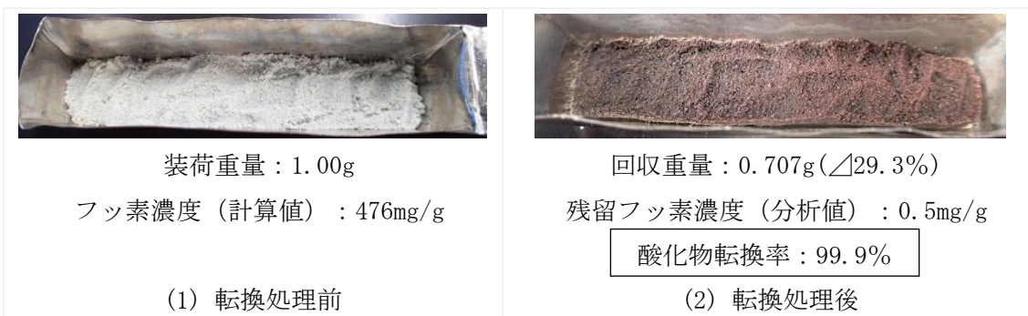
図 3.2.3-2 試薬試験①の転換処理前後の外観及び酸化物転換率
