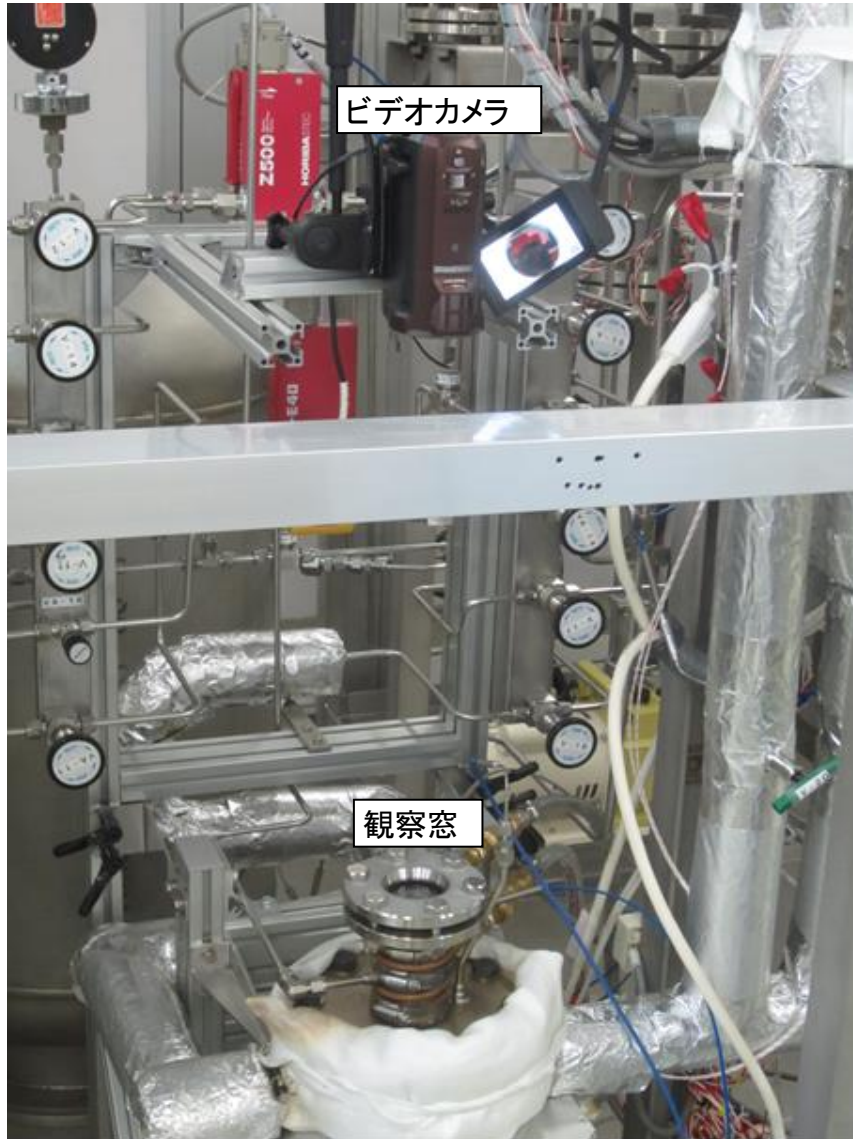
図 3. 1. 1. 3-3 ビデオカメラによるニッケル反応塔内部撮影状況
