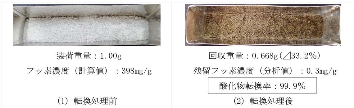
図 3. 2. 3-5 試薬試験②の転換処理前後の外観及び酸化物転換率
