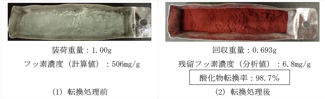
図 3. 2. 2-2 FeF 3 の転換処理前後の外観及び酸化物転換率
