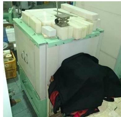
図 3.3.2.④-3 ^{252}\text{Cf} 熱中性子源
