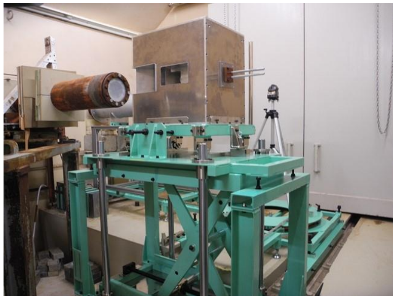
図 3. 1. 1. (2). ②-3 新しく導入した中性子源システムと昇降式架台の写真
