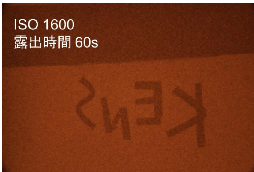
図 3. 2. 1. (1). ②-3 パルス中性子を用いた試作高空間分解能型検出器による撮影結果 (ISO1600、露出時間 60 s)
