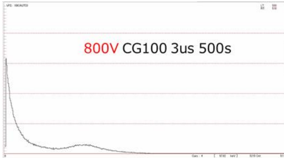
図 3.3.2.④-4 Li ガラス・ピラー型 3mm 角シンチレータの中性子スペクトル
