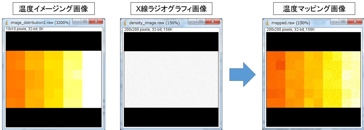
図 3. 2. 2. (1). ②-5 X 線ラジオグラフィ画像への温度イメージングのマッピング
