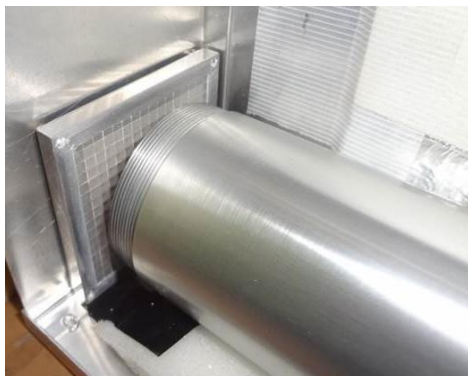
図 3.3.2.④-2 シンチレータとプローブ (応用光研製 SP-10)
