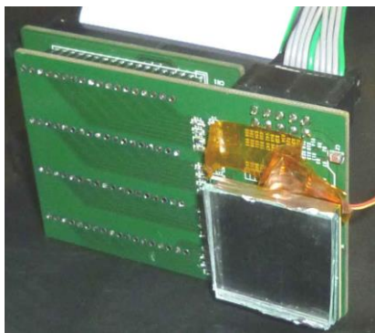
図 3. 3. 1. (2). ④-3 (a) MPPC アレイ検出器 (b) CA32M_DAC 基板 2 枚と CA32M_HV 基板+高速アンプ
