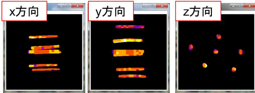
図 3.2.1. (1). ⑤-4 位置合わせ後の X 線及び中性子画像の相乗イメージングの結果
