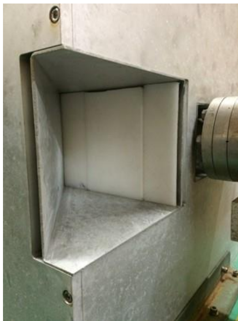
図 3.1.1.(2).③-1 減速材 (厚さ 5 cm) を挿入した時の中性子源システムの写真
