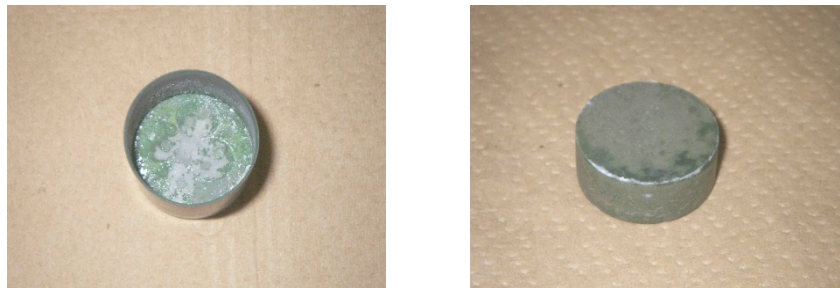
図 3. 2. 4-13 固化体製造後の試料容器（左）及び内部から取り出した固化体の外観（右）
