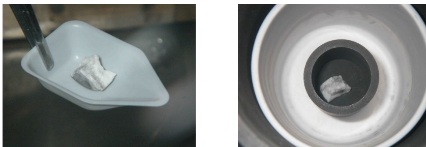
図 3.2.4-6 Gd 沈殿を含む LiCl-KCl 塩塊の蒸留試験に用いた試料
