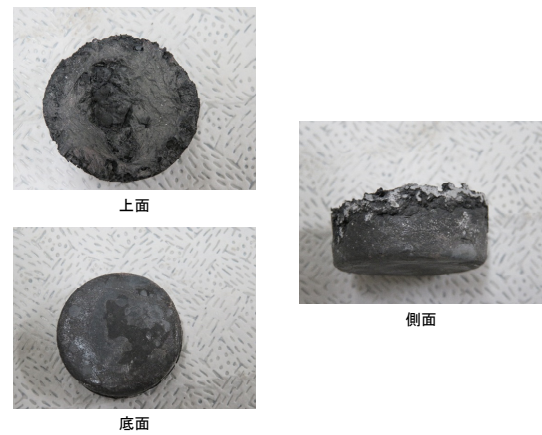
図 3. 2. 4-35 冷却後にくつぼから取 り出した固化体の外観 (NM_Y_1600_30_1)
