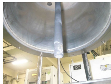
図 3.2.4-9 昇降部に取り付けた加圧軸 (左: 加圧軸取り付け部分、右: 加圧軸先端部分)
