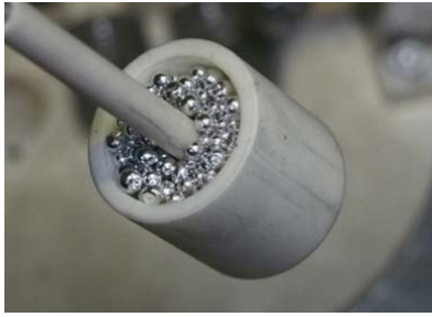
(a) 試験に用いた Cd 陰極
