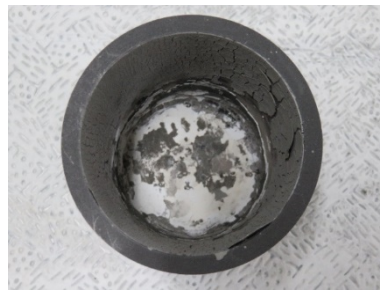
図 3. 2. 4-47 固化体取り出し後のグラファイトるつぼ内側の様子 (NM_Y_1600_30_2)
