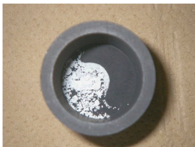
図 3.2.4-7 Gd 沈殿を含む LiCl-KCl 塩塊の蒸留試験後の試料るつぼ内の様子
