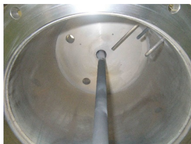
図 3.2.4-9 昇降部に取り付けた加圧軸 (左: 加圧軸取り付け部分、右: 加圧軸先端部分)
