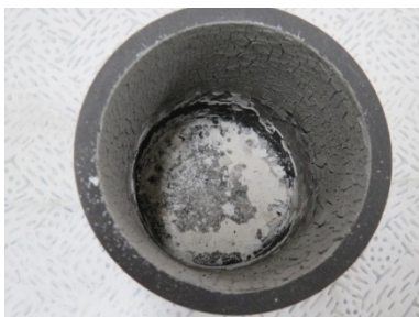
図 3. 2. 4-36 固化体取り出し後の グラファイトるつぼ内側の様子 (NM_Y_1600_30_1)
