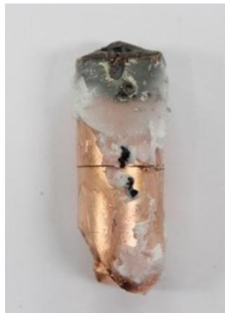
図 3.3-3 Cu-(Ru, Nb, Fe) 試料の加熱溶融後の外観
