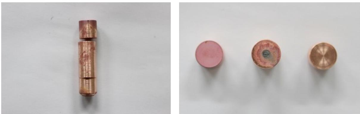
図 3.3-22 Cu-Zn 試料の加熱溶融試験後の外観
