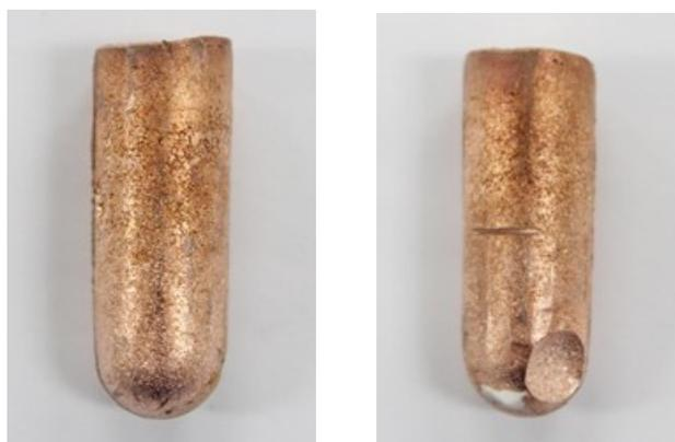
図 3.3-12 Cu-Ni 試料の加熱溶融試験後の外観
