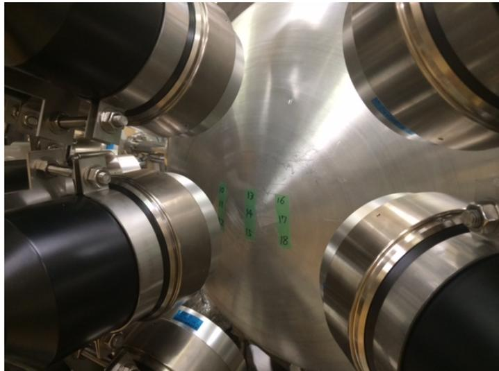
図 3.1.2-2: 中性子検出器の配置 (上) と一部の拡大図 (下)
