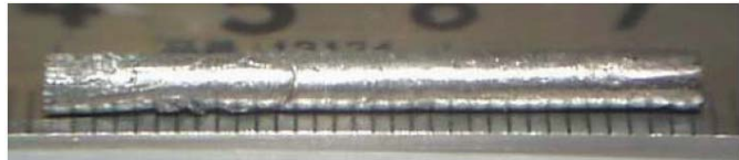
図 1 射出鋳造した U-Pu-RE-Zr 合金燃料スラグ
