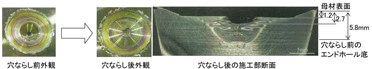
図-3 穴ならし法の試験結果
