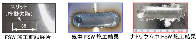
図－7 FSW施工部外観
