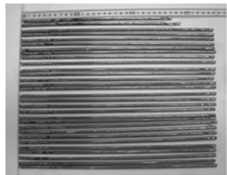
図3 射出鋳造の結果 射出鋳造で得られたU-10wt.%Zr合金ロッド(上の2本はモールドにコーティングせず)
