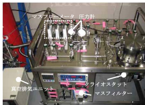
図2. 本事業で開発した動的量子分子篩効果測定装置。
