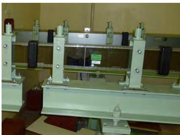
図3：ビームホール内導管室における新規製作したスーパーミラー中性子鏡管ユニット(手前が C3 冷中性子ビームライン)
