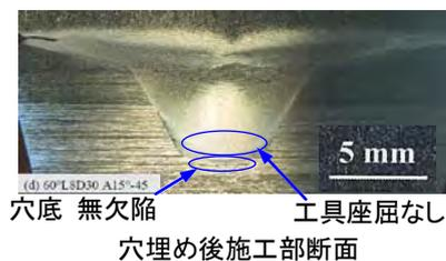
図-3 穴埋め法の試験結果
