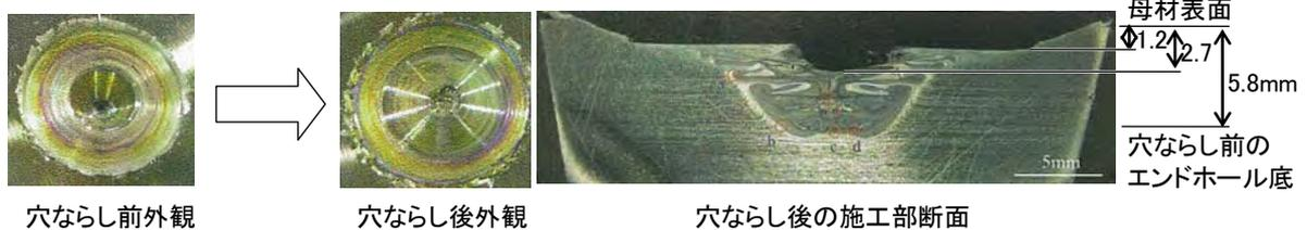
図-2 穴ならし法の試験結果
